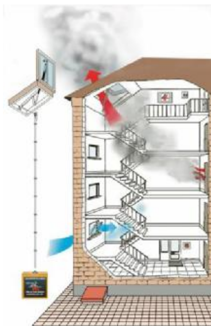
Рис. 4. Удаление дыма с помощью электрического привода
